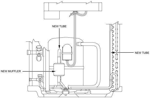
Fig. 2—38TKB030-311 Muffler Kit Installation
